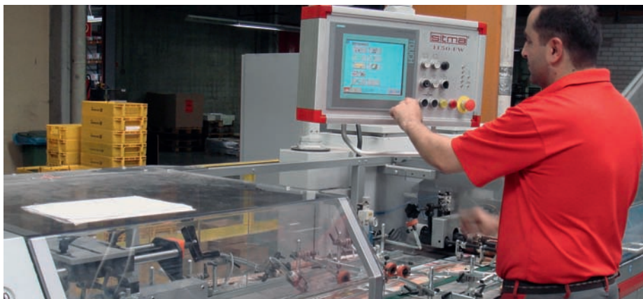
Die Folienverpackungsmaschine Sitma W1150 arbeitet mit bis zu 18000 Takten pro Stunde.
