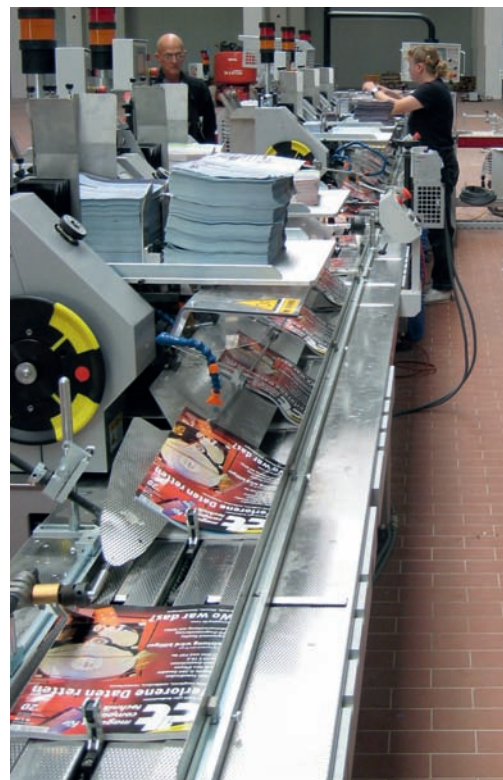
Die Einsteckanlage Sitma M3 verfügt über sechs servoangetriebene Beilagenanleger.
